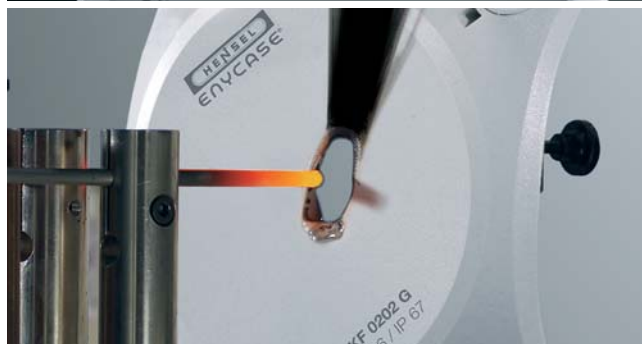
Ponašanje pri testiranju zapaljivosti užarenom žicom na 960 °C Izdržljivost visokog udara od IK 09 (10 džula)
